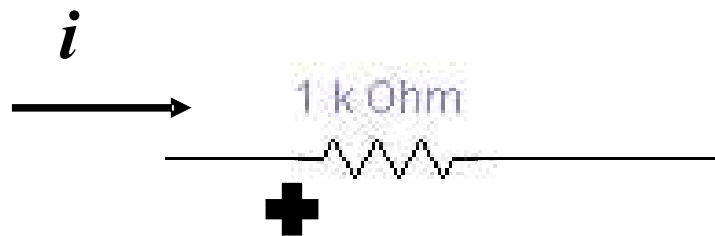
FIGURA 47. CORRIENTE ENTRANDO A UNA RESISTENCIA - POLARIZACIÓN
