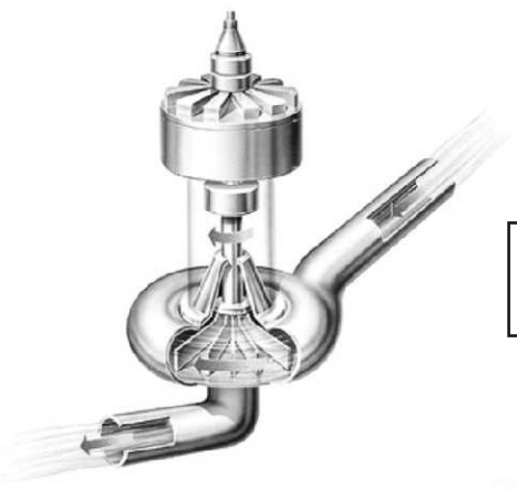
FIGURA 3. GRUPO TURBINA GENERADOR ELÉCTRICO. Fuente: www.mheine.com Copyright: Holt Reinhart Winston
